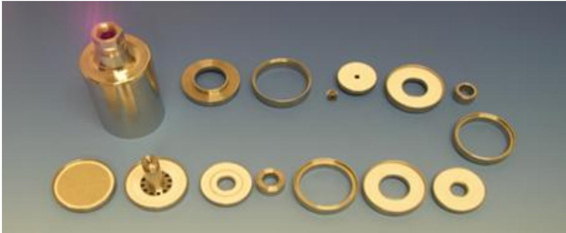
图 2 采样头内部切割器构造
